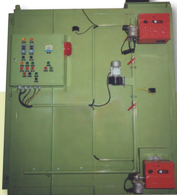
Horno pirolítico "CALTEC" para tratamiento de autopartes con revestimientos químicos.
